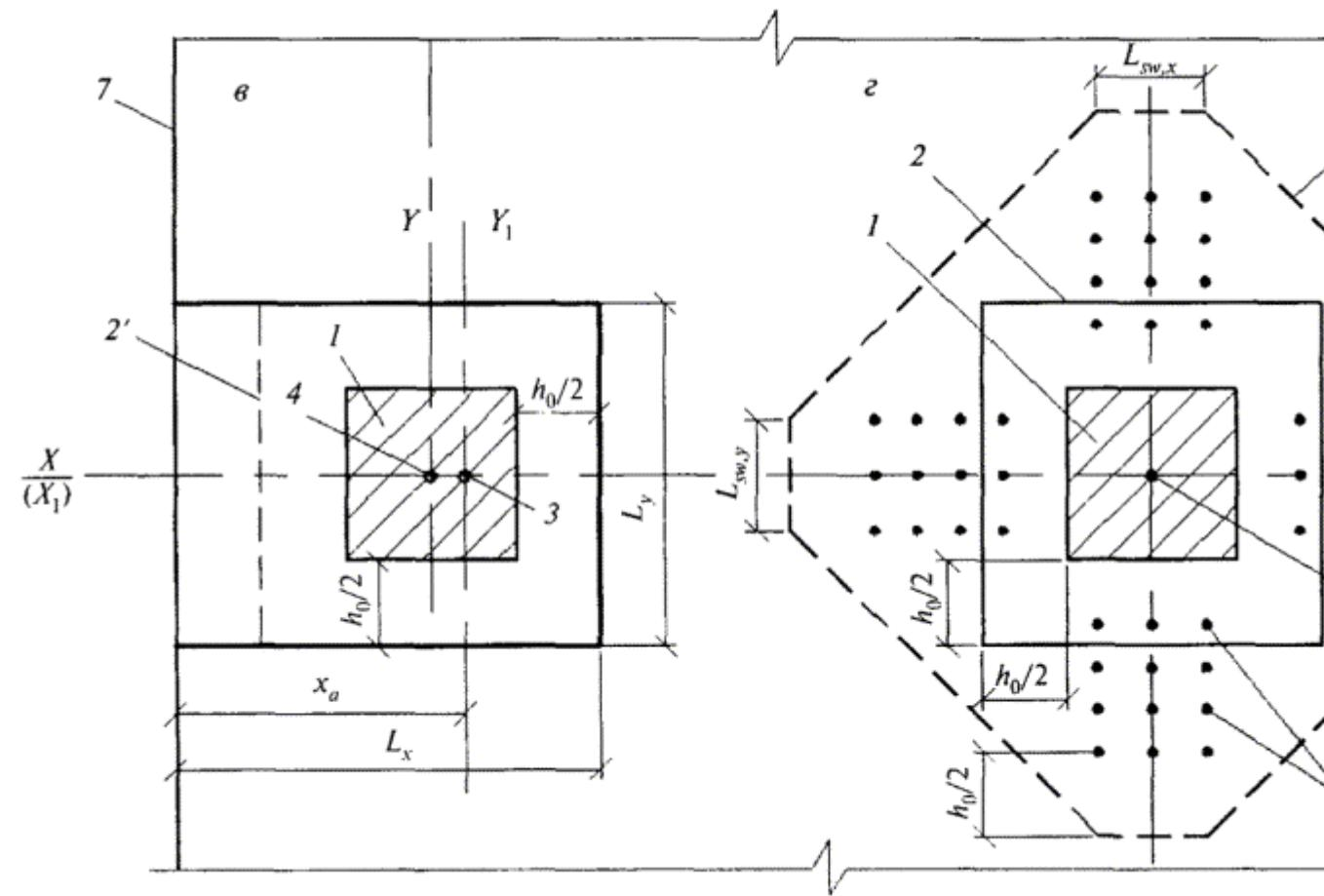
*a* - площадка приложения нагрузки внутри плоского элемента; *б, в* - то же, у края плоского элемента; *г* - при крестообразном расположении поперечной арматуры
