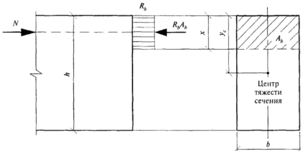
**Рисунок 6.1** - Схема усилий и эпюра напряжений в сечении, нормальному к продольной оси внецентренно сжатого бетонного элемента, рассчитываемого по прочности без учета сопротивления бетона растянутой зоны
