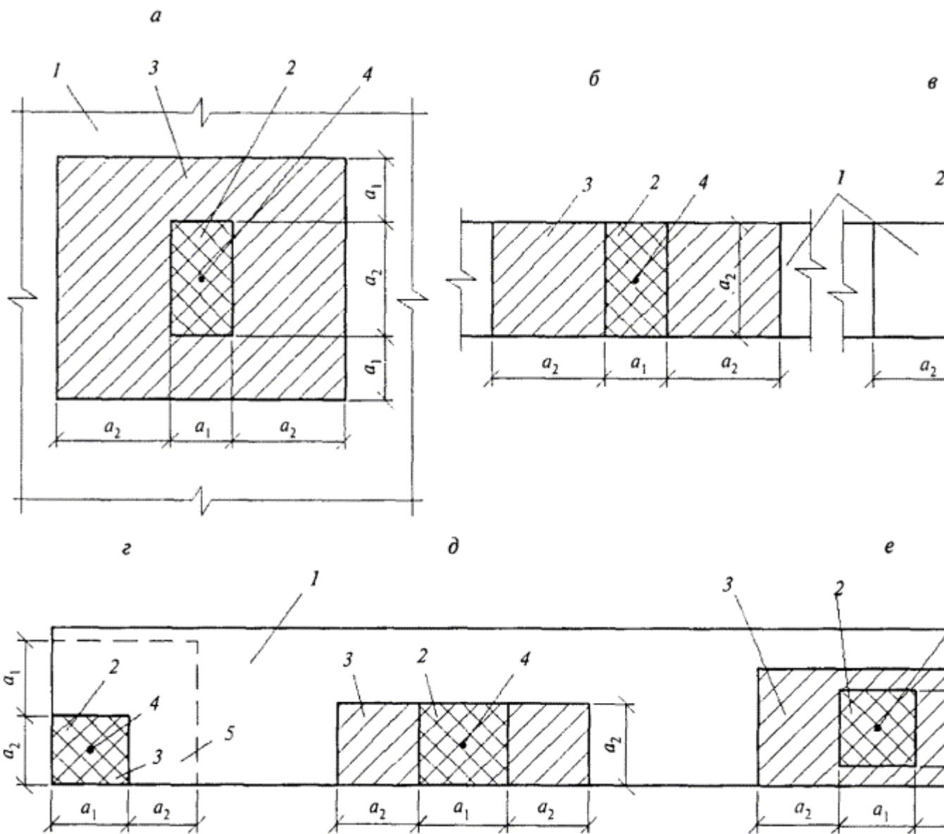
*a* - вдали от краев элемента; *б* - по всей ширине элемента; *в* - у края (торца) элемента по всей его ширине; *г* - на углу элемента; *д* - у одного края элемента; *е* - вблизи одного края элемента
