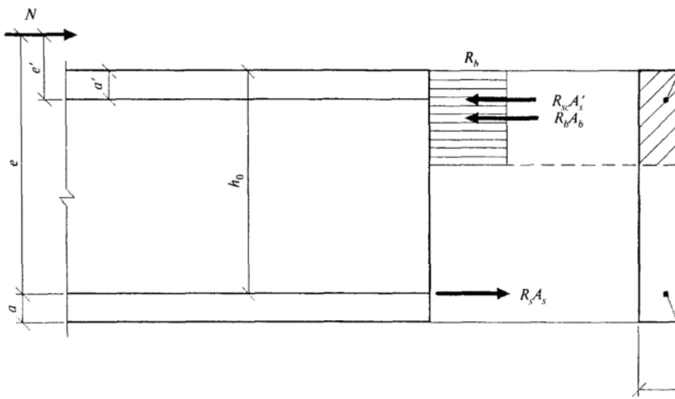
**Рисунок 6.5** - Схема усилий и эпюра напряжений в сечении, нормальному к продольной оси внецентренно сжатого железобетонного элемента, при расчете его по прочности
