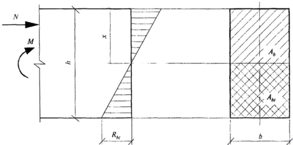
**Рисунок 6.2** - Схема усилий и эпюра напряжений в сечении, нормальному к продольной оси изгибаляемого (внеклентренно сжатого) бетонного элемента, рассчитываемого по прочности с учетом сопротивления бетона растянутой зоны
