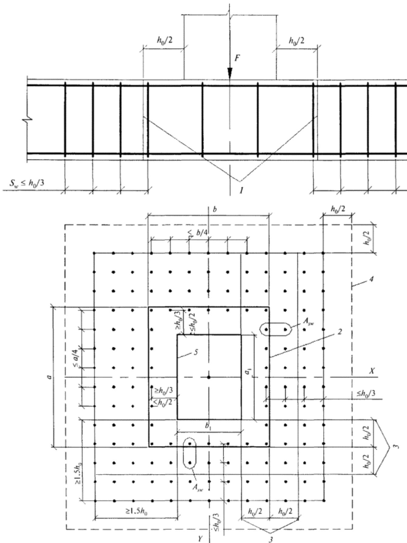
1 - расчетное поперечное сечение; 2 - контур расчетного поперечного сечения; 3 - границы зоны, в пределах которых в расчете учитывается поперечная арматура; 4 - контур расчетного поперечного сечения без учета в расчете поперечной арматуры; 5 - контур площадки приложения нагрузки
