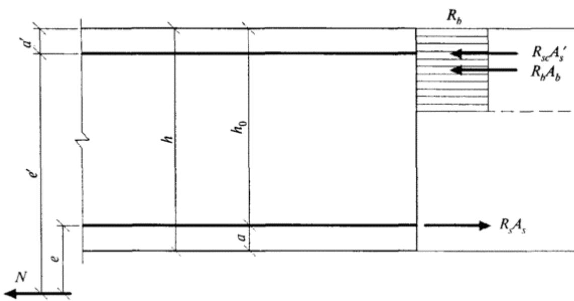
*а* - между равнодействующими усилий в арматуре  $S$  и  $S'$ ; *б* - за пределами расстояния между равнодействующими усилий в арматуре  $S$  и  $S'$
