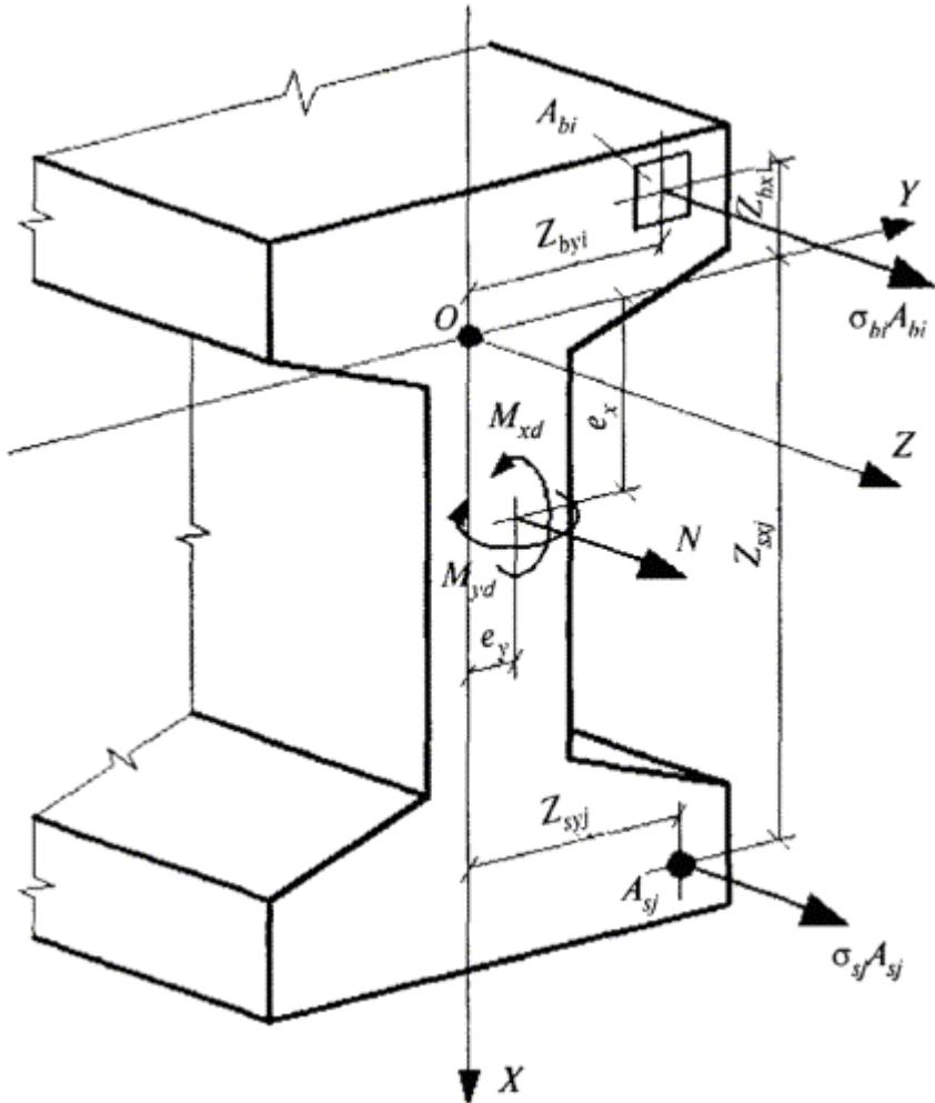
**Рисунок 6.7** - Расчетная схема нормального сечения железобетонного элемента
