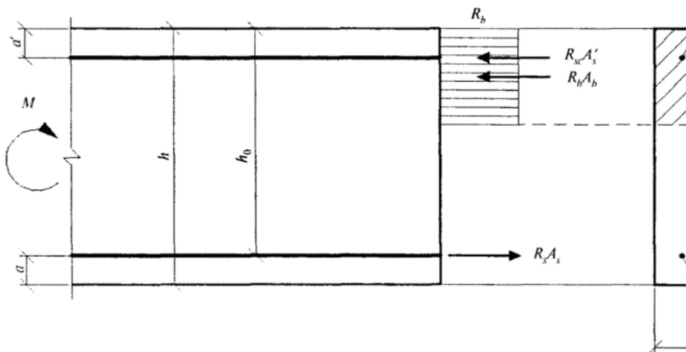
**Рисунок 6.3** - Схема усилий и эпюра напряжений в сечении, нормальному к продольной оси изгибающего железобетонного элемента, при его расчете по прочности
