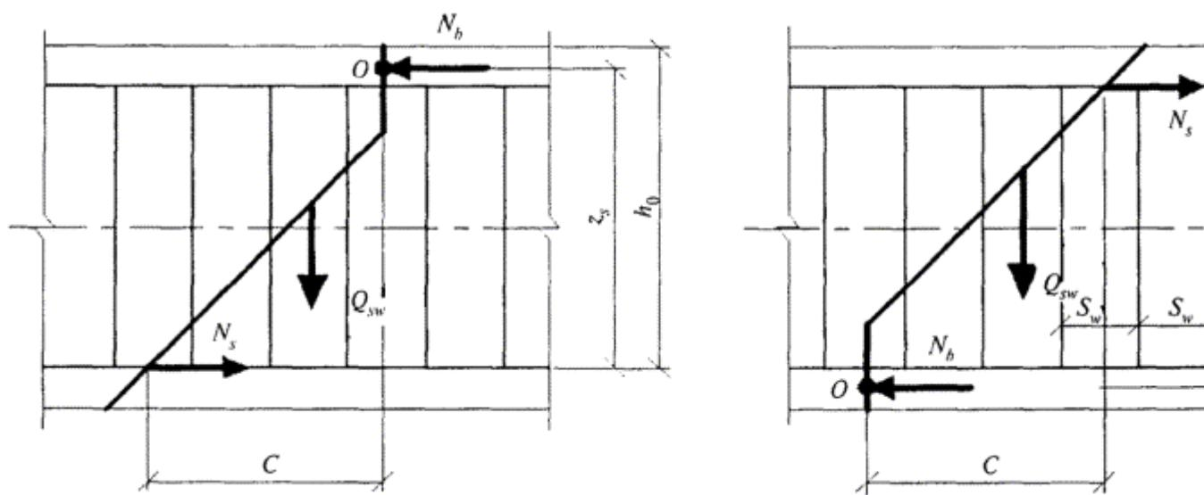
**Рисунок 6.9 - Схема усилий при расчете железобетонных элементов по наклонному сечению на действие моментов**
