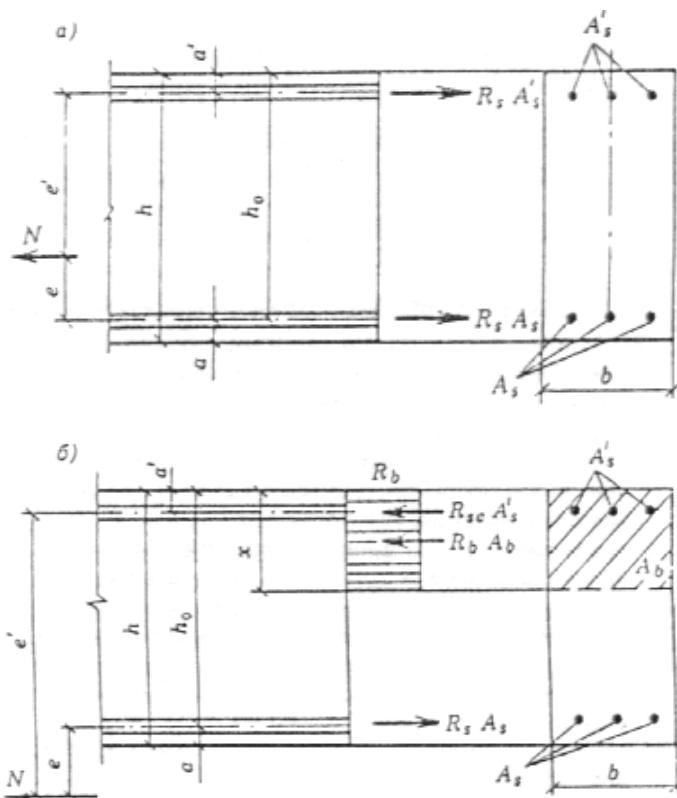
Черт. 7. Схема усилий и эпюра напряжений в сечении, нормальному к продольной оси внецентренно растянутого железобетонного элемента, при расчете его по прочности
