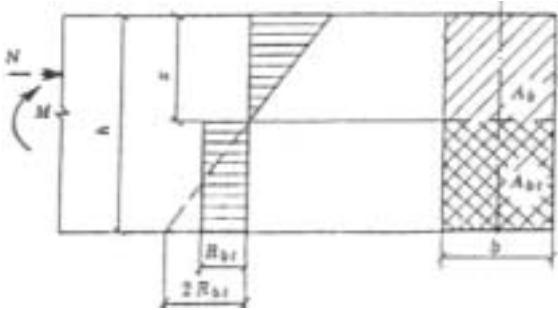
Черт. 3. Схема усилий и эпюра напряжений в сечении, нормальному к продольной оси изгибаляемого (внеклентренно сжатого) бетонного элемента, рассчитываемого по прочности с учетом сопротивления бетона растянутой зоны.
