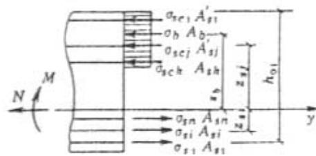
Черт. 23. Схема усилий и эпюра напряжений в сечении, нормальном к продольной оси элемента, с многорядным армированием при расчете по деформациям
