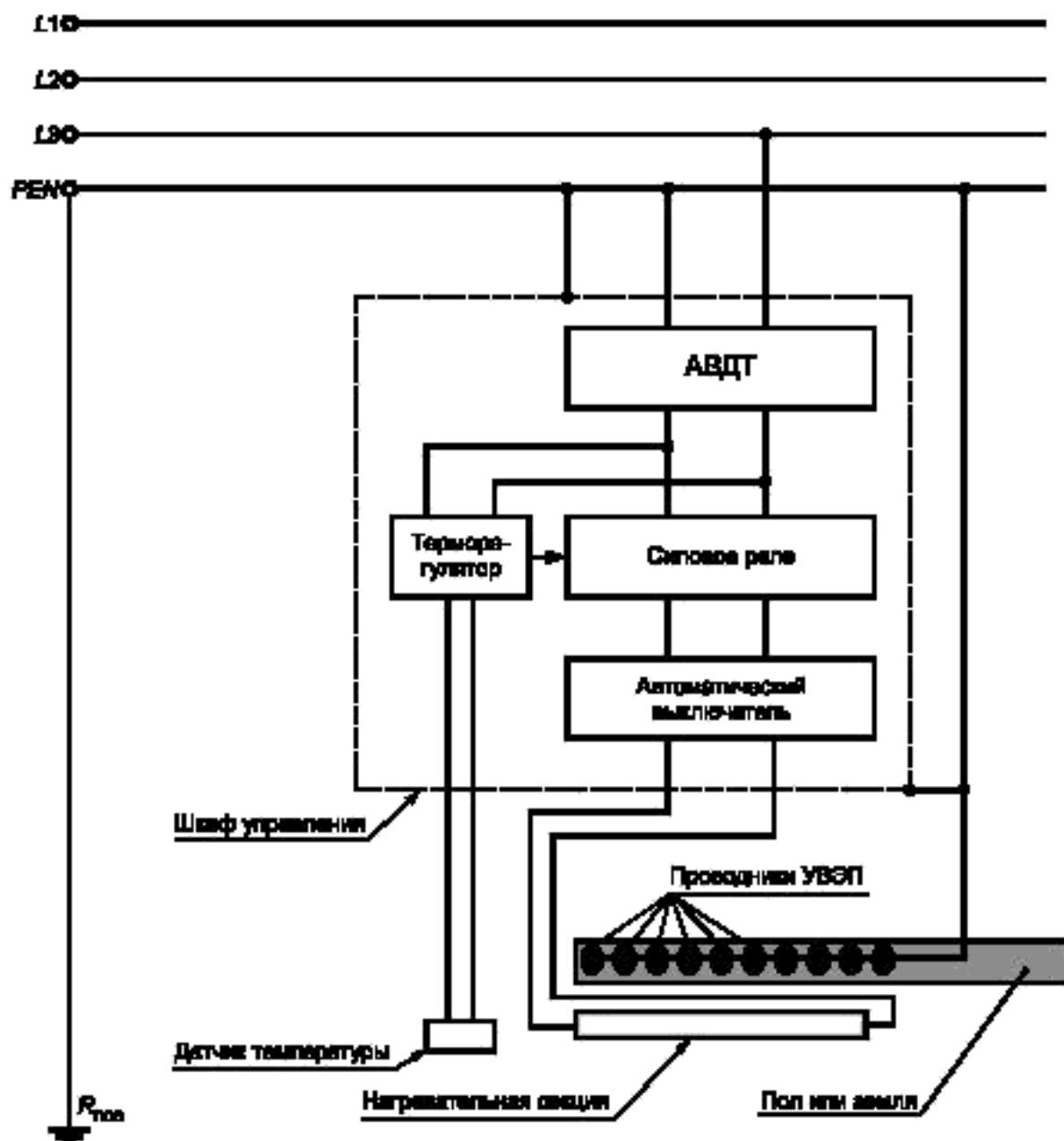
АВДТ — автоматический выключатель дифференциального тока по ГОСТ Р 51327.1;  $R_{\text{заз}}$  — заземлитель повторного заземления PEN-проводника; УВЭП — устройство выравнивания электрических потенциалов
