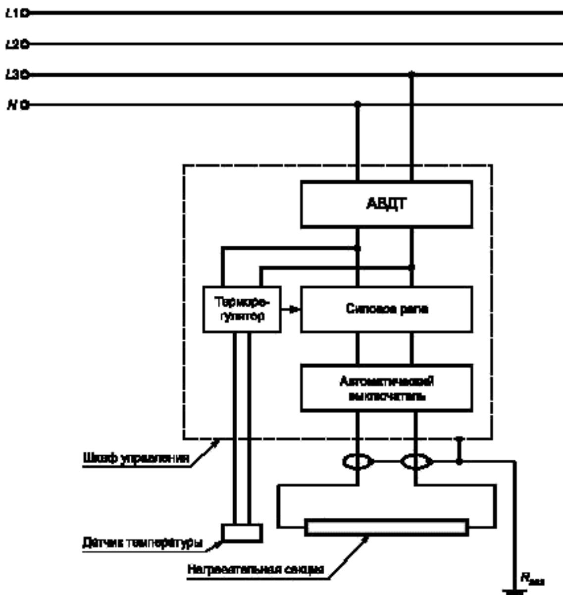
АВДТ — автоматический выключатель дифференциального тока по ГОСТ Р 51327.1;  $R_{\text{заз}}$  — заземлитель установки
