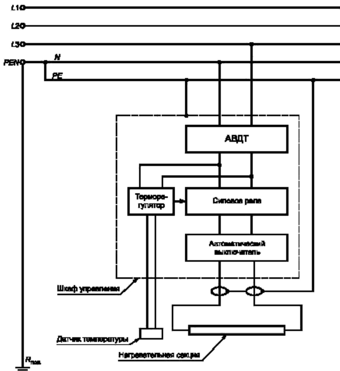
АВДТ — автоматический выключатель дифференциального тока по ГОСТ Р 51327.1;  $R_{闪过}$  — заземлитель повторного заземления PEN-проводника
