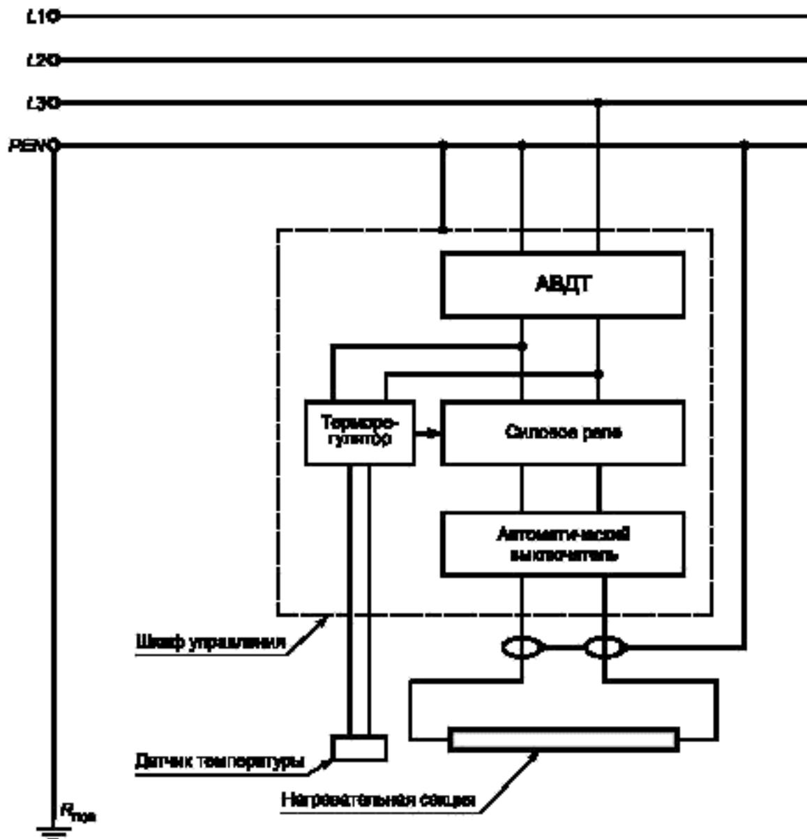
АВДТ — автоматический выключатель дифференциального тока по ГОСТ 51327.1,  $R_{поп}$  — заземлитель повторного заземления PEN-проводника
