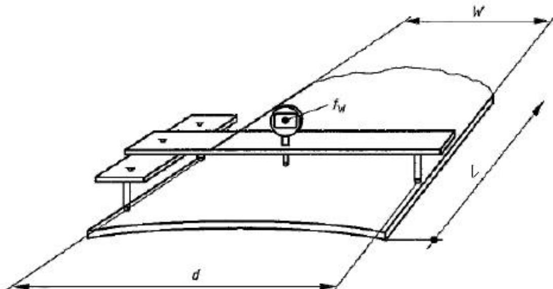
Рисунок А.6— Определение покоробленности по ширине  $f_w$ **A.3.12 Обработка результатов**
