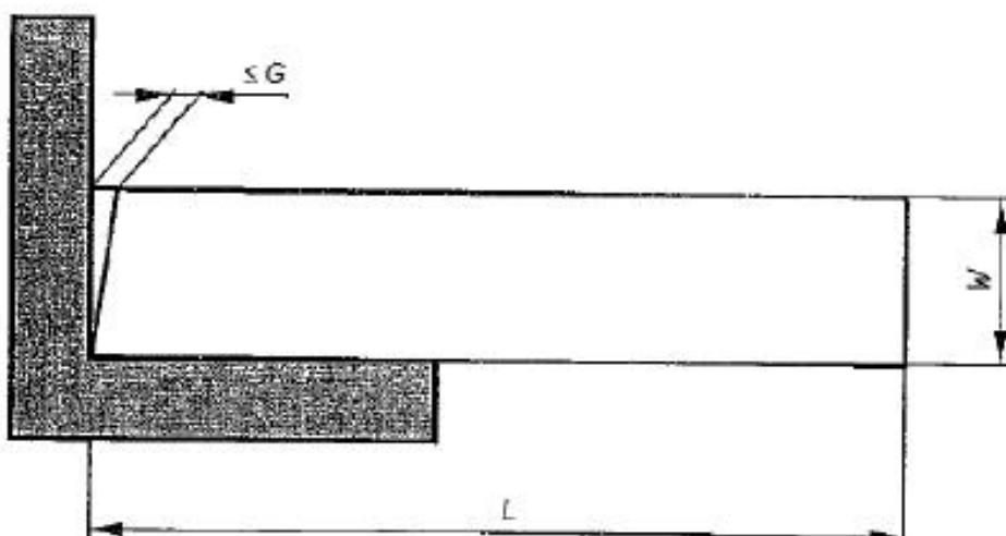
Рисунок А.4 – Определение прямоугольности  $G$
