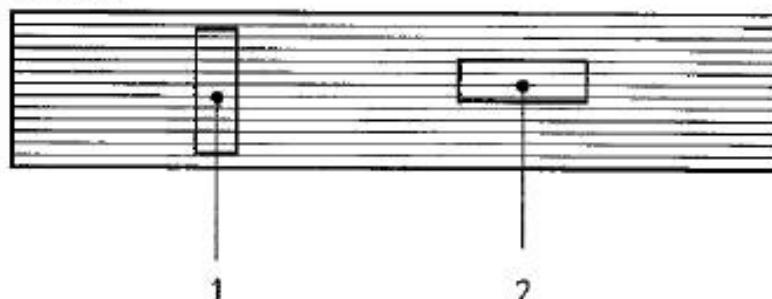
Из элемента ламинированных напольных покрытий выпиливают два образца длиной  $(150 \pm 1)$  мм, шириной  $(50 \pm 1)$  мм, один в поперечном направлении, другой – в продольном, на расстоянии не менее 50 мм друг от друга (рисунок Г.1).
