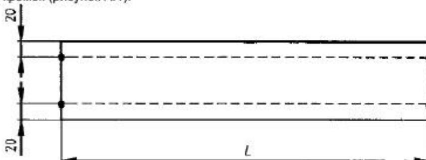
Рисунок А.1 – Точки измерения для определения длины  $L$  (размеры в мм)
