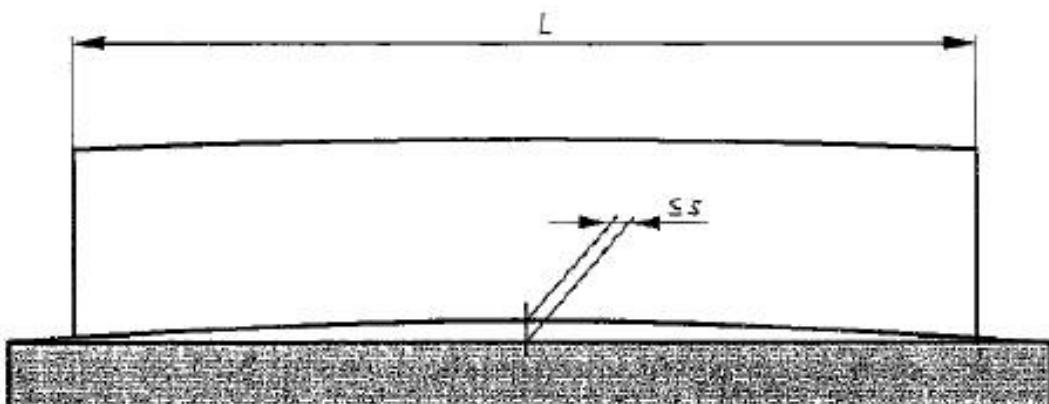
Рисунок А.5 – Определение прямолинейности  $S$ **A.3.10 Обработка результатов**
